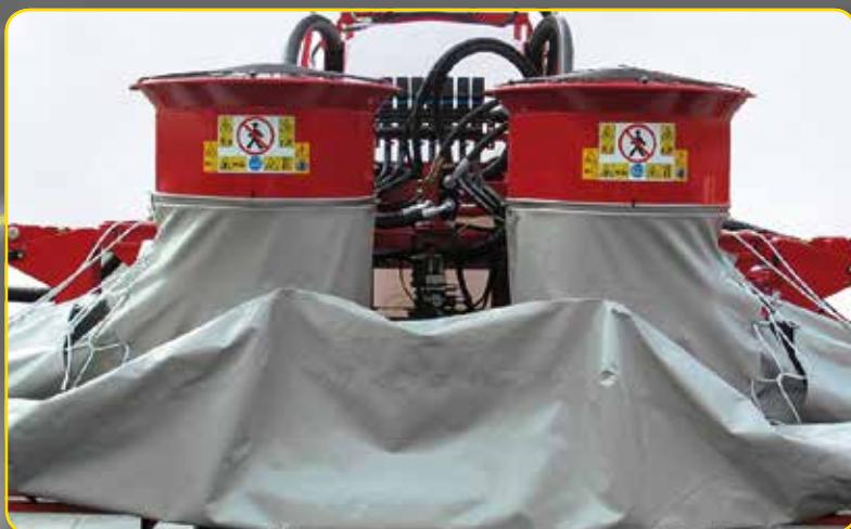
**(IT)** Doppia turbina per barre da 28 a 30 metri
