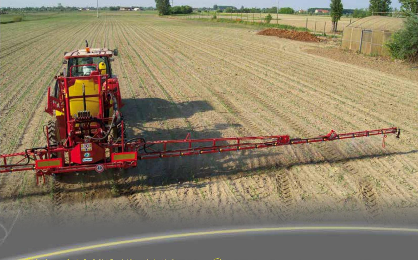
**IT** **Assale ammortizzato.** Peculiarità dell'assale è l'ammortizzatore idraulico connesso ad un impianto con azoto ad alta pressione. Autoregolante in base alla quantità del liquido nel serbatoio.
